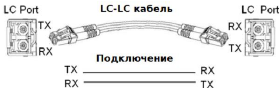
Рис. 15. Подключение оптического кабеля к оптическому трансиверу
